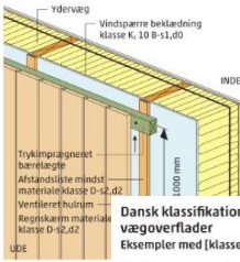
Figur 798 Regnskærm af vindspærre af beklædning på træskeletydervæg.
