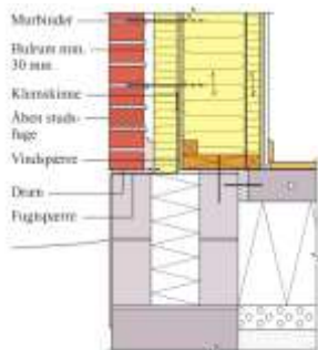
Figur 44 Søjkel ved skalmuret facade med beskyttet vindspærre.
