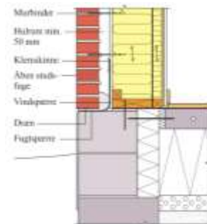
Figur 45 Søjkel ved skalmuret facade med beskyttet vindspærre.
